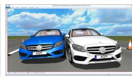
ASM ツールスイートでシミュレートしたステップステアリング操作において、2 つの異なるシャシタイプの車両の挙動を重ね合わせた表示。次のサイトで運転操作の動画をご覧いただけます: www.dspace.jp/go/dMag\_20181\_steer
