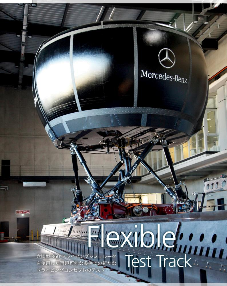
Daimler AG では、シャシ、ビークルダイナミクスコントローラ、および先進運転支援システムのコンセプトを見極め、その妥当性を確認するため、道路上でのテストドライブに加えてドライビングシミュレータを利用しています。その最大の利点は、テストドライバーと実車をまさに操作の中心にしてテストを行えることです。
